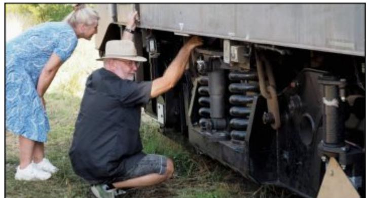
Nach mehrjähriger „Rast“ auf dem Gelände des Berthelsdorfer Bahnhofes ging die Diesellok der BR 218 im August 2023 auf Schienenkurs in ihre neue Heimat. Zuvor musste das tonnenschwere Kraftpaket auf neue Fahrgestelle gesetzt werden. Für den neuen Besitzer (rechts) soll sie zur Ersatzteilgewinnung seiner Lok-Flotte der Railsystems RP GmbH Gotha dienen.
